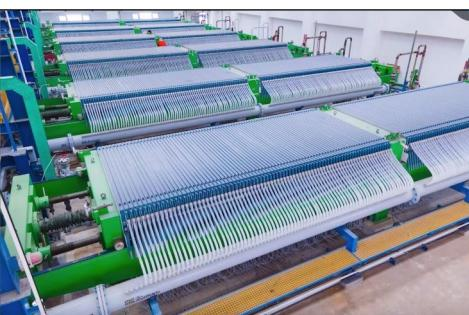
氯碱电解车间的核心设备。主要由单元槽、离子交换膜、相关配套设备及部件成套组合而成，是电解化学反应发生的主要场所。主要用于生产烧碱和氯气，为基础化学工业提供原料，广泛应用于建筑型板管材制造、塑料膜生产、有机化学品合成、造纸、玻璃制造、化纤生产等诸多领域。 |
